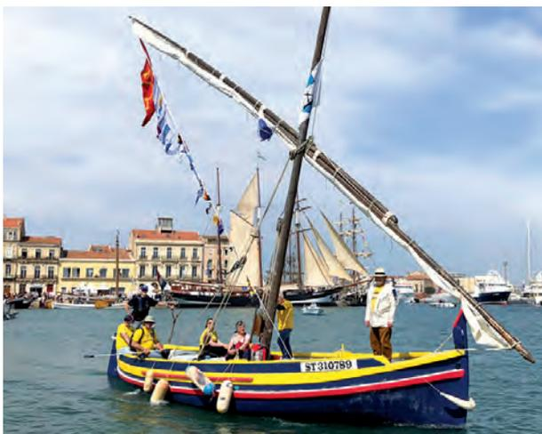
*Prägte durch Jahrhunderte die Schiffe der mediterranen Seefahrer: der eine Mast mit der schrägen Rah, die das dreieckige Lateinersegel trägt.*
