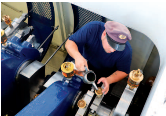
Die Ölpender der Kurbelwelle des historischen Raddampfers werden nachgefüllt.
