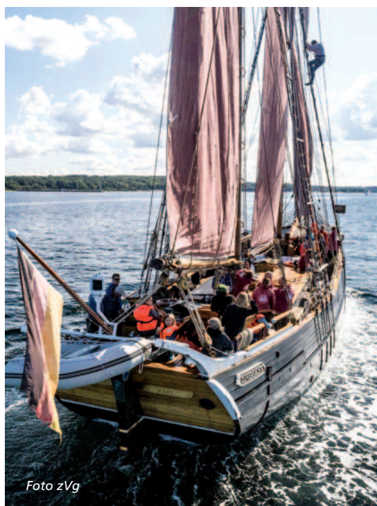
Schoner "Zuversicht", vormals "Leo", Baujahr 1905, Länge über alles 30 Meter, Höhe Grossmast über Deck 24 Meter, 7 Segel, Segelfläche 300 m 2
